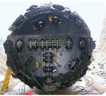
Bohrkopf der Tunnelbohrmaschine
